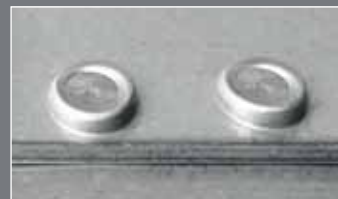
moderne Verbindungsart Tox
