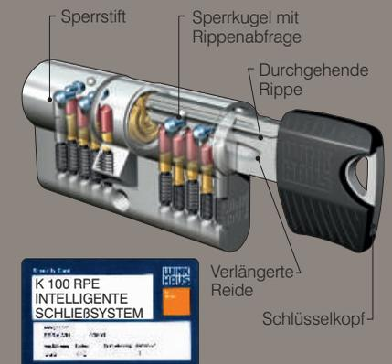
Vielseitig und sicher - heute und in Zukunft. keyTec RPE von Winkhaus ist das innovative System für die einzelgesicherte Schließung. Ein neuartiger Kopierschutz gibt Ihnen die Gewissheit, dass nur befugte Personen einen Nachschlüssel anfertigen können. Dies wird erreicht durch eine speziell ausgeprägte Rippe am Schlüssel, die im Schließzylinder durch eine Sperrkugel abgefragt wird.
