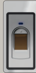
BT 512 2 Relais FINGERSCAN mit 1000 Speicherungen
